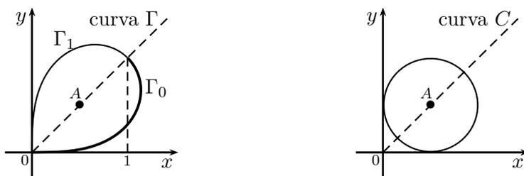
Figura 3: Arco de curva  $\Gamma \equiv (x^2 + y^2)^2 = 4xy$ ,  $x, y \geq 0$  y circunferencia  $C$
